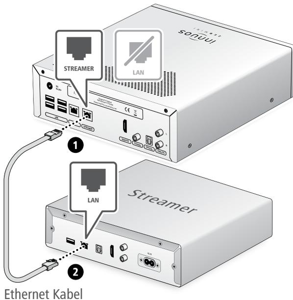
Der Streamer-Port bietet für Streamer, WLAN-Lautsprecher und andere Netzwerk-Audio-Produkte eine kabel-basierte Netzwerk-Verbindung an.
