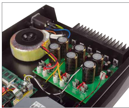
Das neue Netzteil liefert nun getrennt Energie an die jeweiligen Baugruppen des Servers
