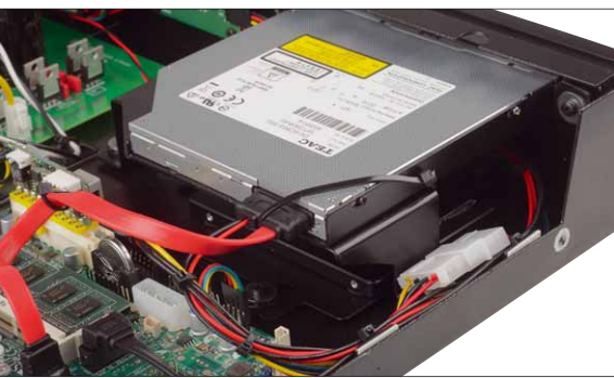
Chassis, Laufwerk und SSD sind jeweils speziell gegen Vibrationen geschützt
