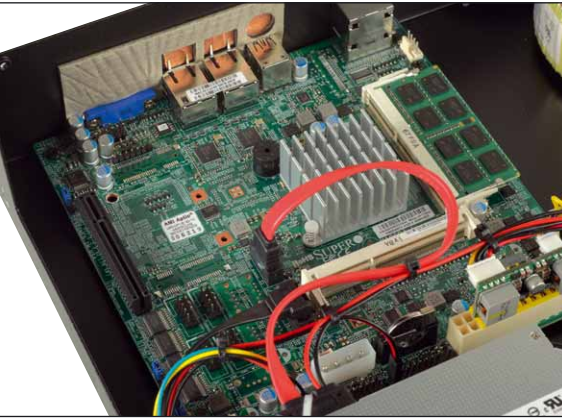
Dank passiver Kühlung kommt der zentrale Prozessor des Zen völlig ohne lärmenden Lüfter aus
